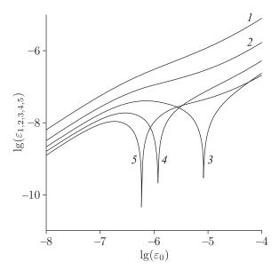
Рис. 6. Зависимости амплитуд  $\varepsilon_n(z)$  первых пяти гармоник от  $\varepsilon_0$  при  $\gamma_0=10^6,\ y=3\cdot 10^6,\ \mu=1.5,\ \lambda=2.$
